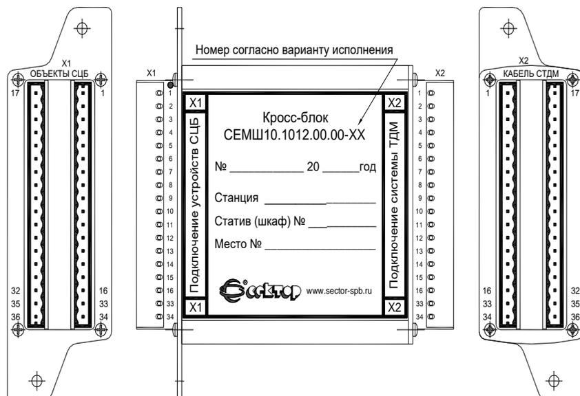
Рисунок 1 - Внешний вид и маркировка кросс-блока
